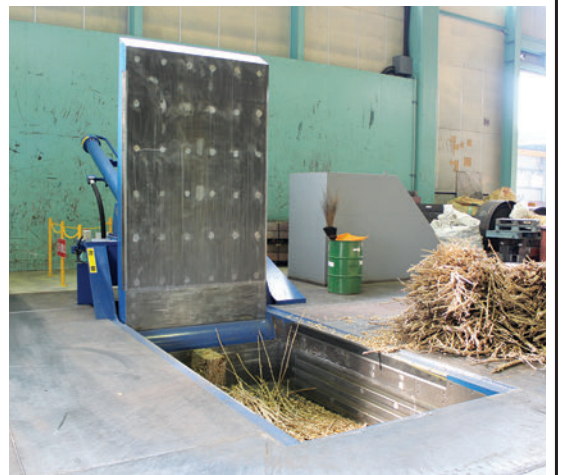
モリタ環境テック製の三方締めプレス
